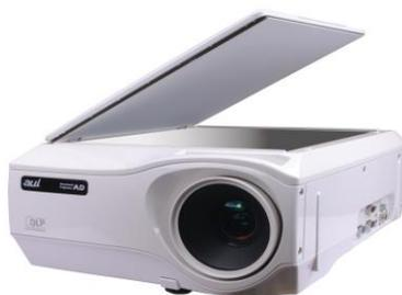
「AD-2000X」は、現在国内唯一の書画カメラ内蔵プロジェクターの追加モデルとなり、印刷物や立体物をガラス面に載せるだけでそのまま投影、そのままスキャンしてデータ保存することができるドキュメントプロジェクター。スタンダードな長焦点レンズと光学ズーム1.6倍機能を新たに搭載したモデルとなり、従来機種と同様にパソコン画面やビデオ・DVD等の映像はもちろん、HDMI端子やUSB端子を搭載していますので、USBメモリに保存した資料をパソコン無しで投影する事もできます。解像度XGA(1024×768ドット)、明るさは高輝度2,900lm、長焦点レンズ採用で、投影画面までの距離が遠い会議室などでの環境に適しています。
